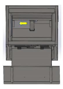
3. THEN MOVE SIDEWAYS UNTIL SUPPORTED BY THE SUPPORT PLATE AND TOUCHING THE SIDE WALL. MAKE SURE THE BAFFLE PLATE ALSO TOUCHES THE REAR WALL.
