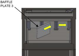
4. AGAIN REPEAT STEP 2 PROCESS BUT THIS TIME TILT THE BAFFLE PLATE THE OPPOSITE WAY. THE BAFFLE PLATE WILL BE INSTALLED ON THE RIGHT HAND SIDE. PUSH ALL THE WAY TO THE SIDE AND BACK.
